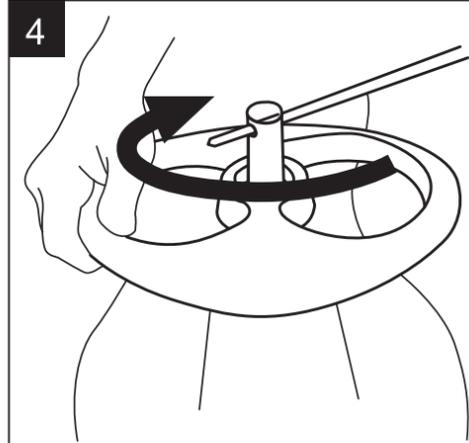
**4** Dieser Schritt ist entscheidend für die Leistung Ihres Magic Cars. Ziehen Sie die Mutter in der Lenksäule mit einem 17-mm-Steckschlüssel SO FEST WIE MÖGLICH AN. Stecken Sie den Schraubenschlüssel auf die Mutter und drehen Sie ihn fest. Verwenden Sie alternativ den mitgelieferten Inbusschlüssel und einen Schraubendreher, um die Mutter SO FEST WIE MÖGLICH ANZUZIEHEN.
