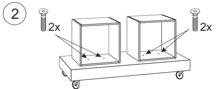
Positionieren Sie die zwei weißen Würfel mit den zwei Bohrungen im Boden über dem Rollpodest und befestigen Sie sie mit jeweils zwei Schrauben.
