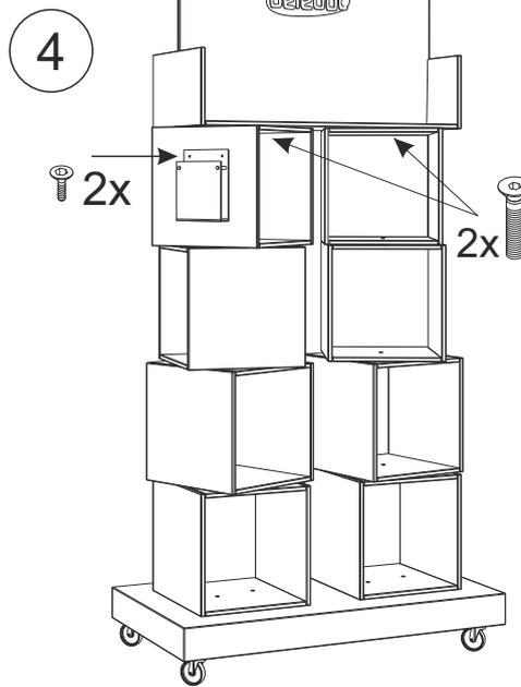
Befestigen Sie den Topper indem Sie zwei Schrauben von unten eindrehen. Abschließend befestigen Sie den Flyer Dispenser seitlich mit den zwei kleineren Schrauben.
