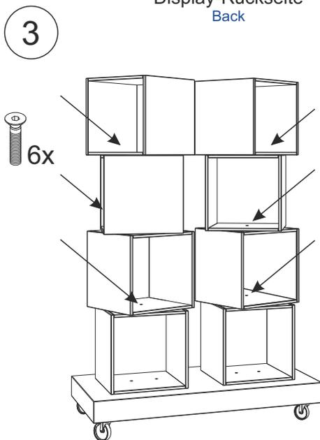
Befestigen Sie die weiteren Würfel mit jeweils einer Schraube, die Sie von oben in den Boden eindrehen. Achten Sie auf die vorgegebene Reihenfolge der Würfel!
